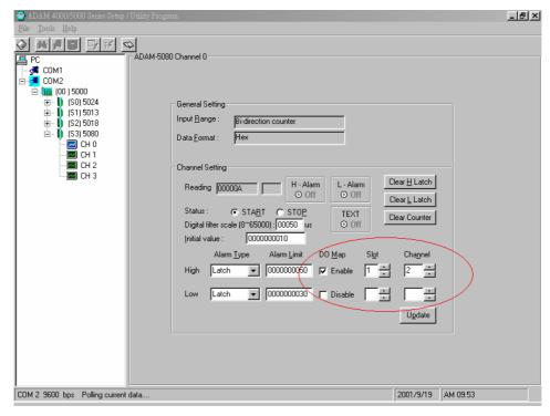
**Figure 6.11 Digital Output Mapping**
