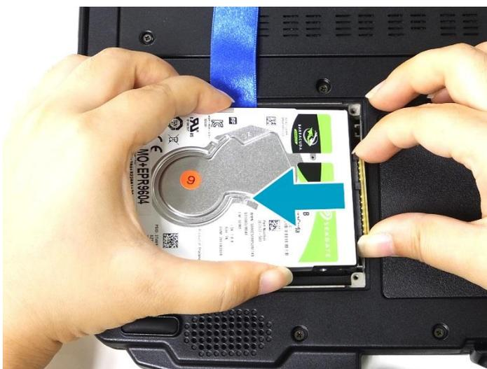
5. Connectez le module du DD au connecteur de la carte mère (visible à l'intérieur du compartiment du DD).
